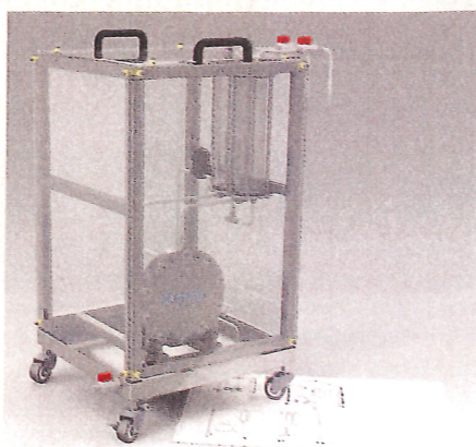
Uitgewerkt 3D-model ter demonstratie van een alkaline elektrolyser. Beeld: Douna Machinery
